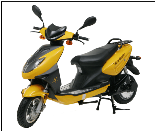
Attēls Nr. 2. Elektriskais mopēds Solar Scooter. Maksimālais ātrums 45km/h, autonomija ar svina-želejas akumulatoriem ir 60km, ar litija akumulatoriem – 150km.
